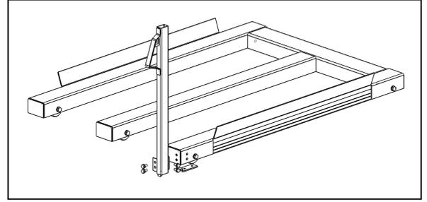
5. Um den Auszug zu herausziehen, den Stift im Griff anheben, wodurch der Verschlussmechanismus angehoben wird. Dieser ist so abgewinkelt, dass die Einheit automatisch verriegelt, wenn sie zurückgeschoben wird.
