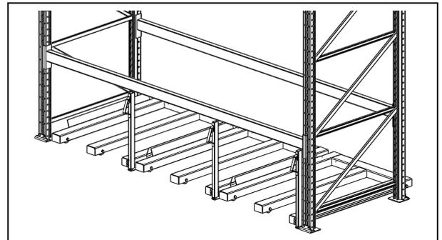
2. Führungsschienen und Anschlagplatte im Fußboden verankern. Es sind vorgebohrte Löcher für die M6-Ankerschrauben vorhanden – Ankerschrauben gemäß den Empfehlungen des Lieferanten. Die Kontaktkräfte auf die Schienen und auf die Anschlagplatten sind nicht übermäßig. Wir empfehlen dennoch Vorsicht beim Herausziehen und Zurückschieben des Palettenauszuges, um die Lebensdauer der Konstruktion zu verlängern.
