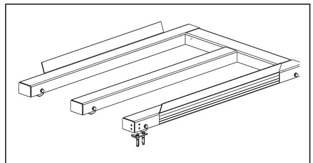
4. Mit den vier M8-Bolzen/Muttern und Unterlegscheiben den Griff am unteren Rahmen montieren.
