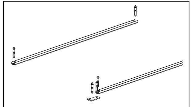
3. Den Palettenauszug über den Führungsschienen anbringen und ausrichten. Der untere Rahmen ist vormontiert und mit Rollen versehen.
