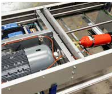
13. Brandsikring i shuttle-enheden.
